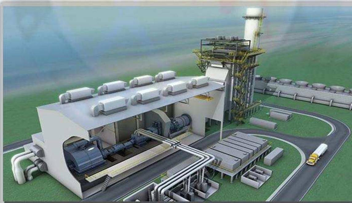
با به کارگیری توربین‌های گازی در چرخه‌های ترکیبی می‌توان پایین بودن بازده آن را بر طرف کرده و در نتیجه آن را برای تامین بار پایه به کار گرفت، در عین حال از مزایای دیگر آن از قبیل راهاندازی سریع و انعطاف‌پذیر در محدوده گستردگی از بار می‌توان بهره‌مند شد.
